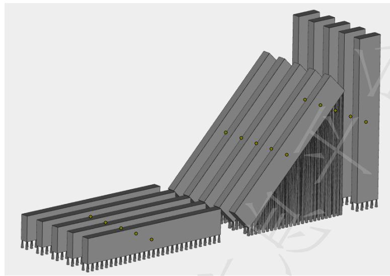
图3 固化后各项异性测试样条摆放示意图
